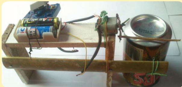
Sumber: Dok. Kemdikbud Gambar 2.35. hasil akhir bel sederhana dengan arus listrik DC.
