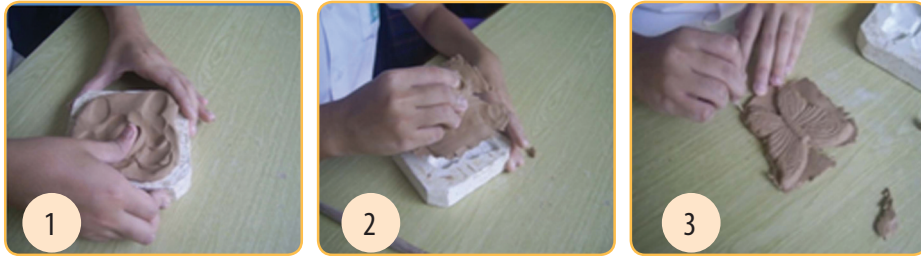
Gambar 1.17. Proses cetak kering dengan cara ditekan ( press ).
