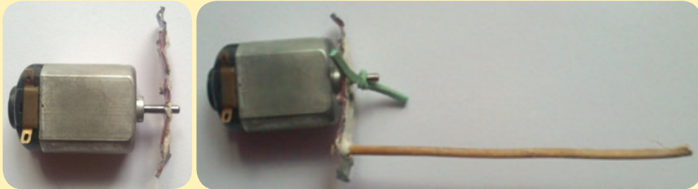
Gambar 2.30. Pemasangan tutup botol dan lidi pada Motor Listrik DC.
